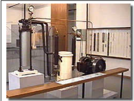
Figura 1.20. Máquina de licuación de Linde (1895) Museo de Munich
