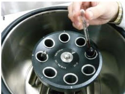
Figura 2.9. Centrífuga de laboratorio
