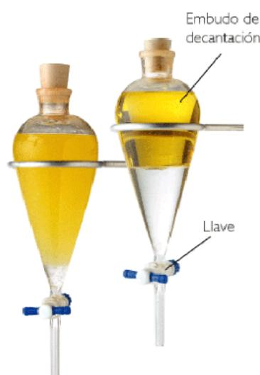
Figura 2.7. Embudo de decantación para separar líquidos inmiscibles de diferente densidad.
