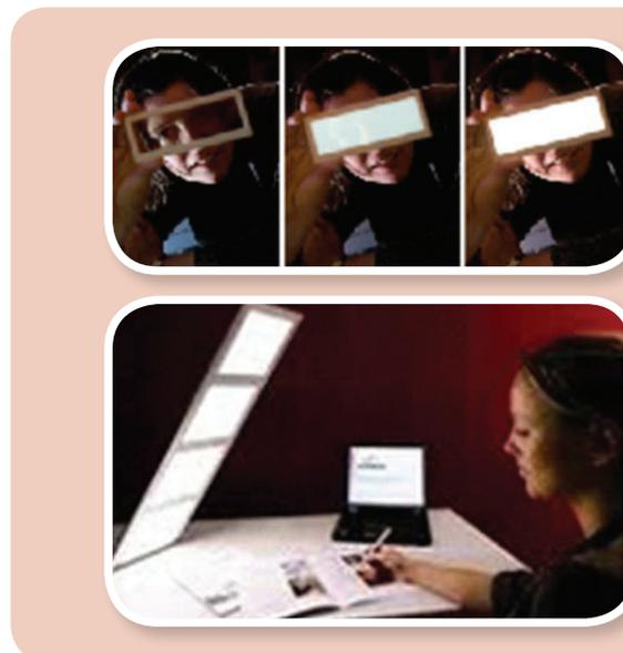
Figura 17: Pantallas OLED transparentes<sup>15</sup>.
