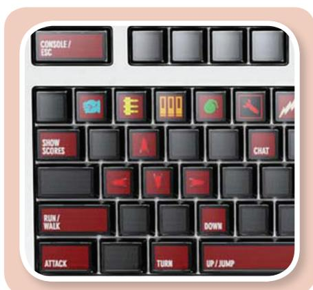
Figura 16: Teclado con teclas basadas en OLED, en este caso configuradas para un juego<sup>14</sup>.
