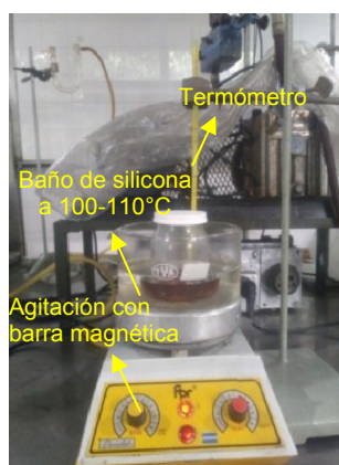
Figura 2 – Reactor sencillo utilizado en la polimerización del aceite maleinizado con glicerina
