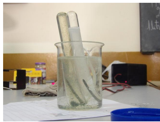
Foto N°4: detalle del ataque a uno de los electrodos de hierro por el producto de la electrólisis generado, la acumulación de un precipitado en el fondo del tubo de color verdoso y la acumulación desigual de los gases liberados en la parte superior de cada tubo.
