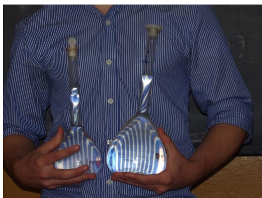
Foto N°1: La transparencia del medio a simple vista permite corroborar la disolución por completo del soluto y la obtención de una solución.
