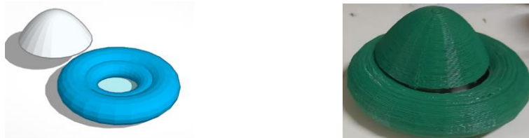
FIGURA 6. A izquierda, modelización de la boya en Tinkercad; a la derecha Prototipo N° 1 impreso en 3D
