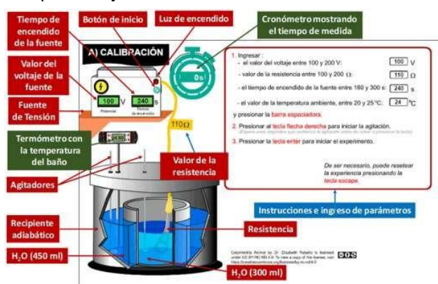
FIGURA 4. Imagen de la interfaz gráfica de la simulación para ejecutar la calibración. En azul se muestran los controles de usuario y en verde la salida de datos.
