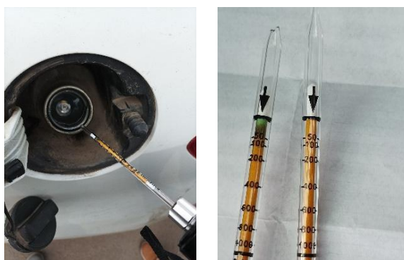
FIGURA 5. Contraprueba realizada sobre la entrada al tanque de combustible de un vehículo naftero con un tubo de HC.
