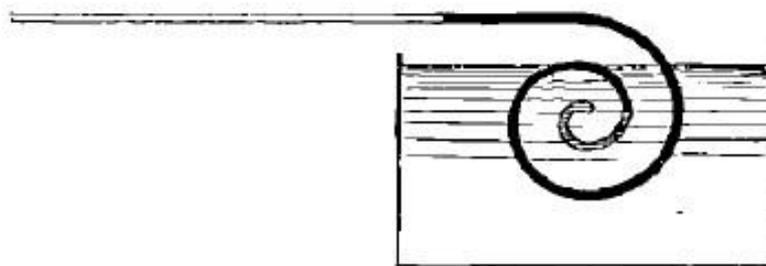
Un extremo del tubo se enrolla en espiral, la parte recta será graduada (de este modo se podrá medir la presión de vapor del mercurio)
