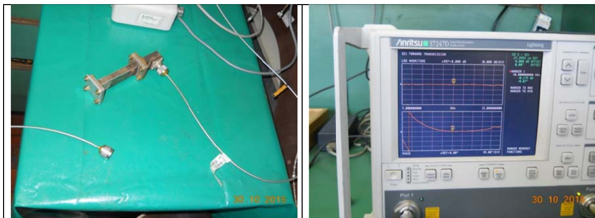
Figura 2 Armado de la línea de transmisión “pasante” para medir los parámetros de scattering S_{11} y S_{21} y calibración con el analizador de red vectorial (VNA).
