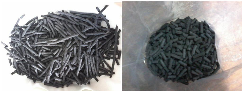
Figura 1. Pelets resultantes secos (izq.) y tratados térmicamente (der.).
