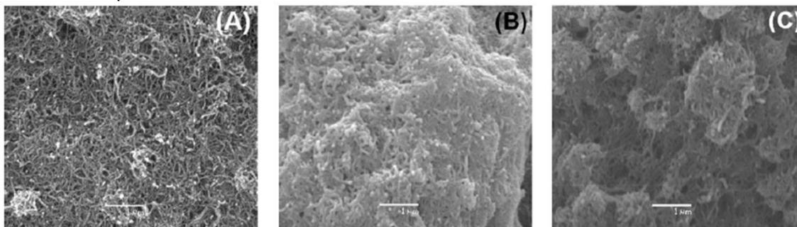
**Figura 1.** Micrografía de la superficie de carbono vítreo modificada con NTCs (A), NTCs-P4VP (B) y NTCs-P4VP/Cu<sup>2+</sup> (C). Ampliación de 20000 veces.
