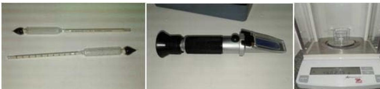
Figura 1: Equipamiento de laboratorio utilizado: a) Aerómetros, b) Refractómetro de campo, c) Balanza electrónica.
