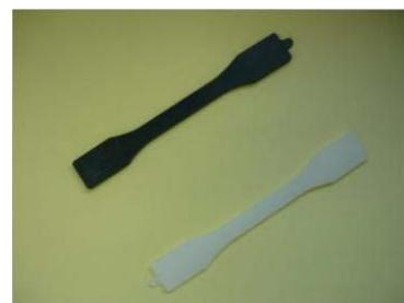
Figura 4: Paletas de PEBD con pyriproxyfen incorporado al 0.5%. Las de color negro se hunden en el agua (ideales para piscinas) mientras que las blancas flotan (ideales para tanques de agua elevados).
