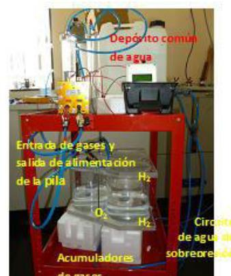
Figura 3. Esquema y fotografía de la configuración de los depósitos de gases.
