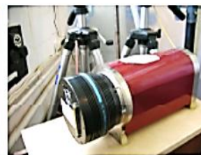
Fig. 1d: Vista del espectrógrafo de dispersión cruzada utilizado, con cámara tipo CCD a la izquierda del mismo. La entrada de luz es vía fibra óptica.
